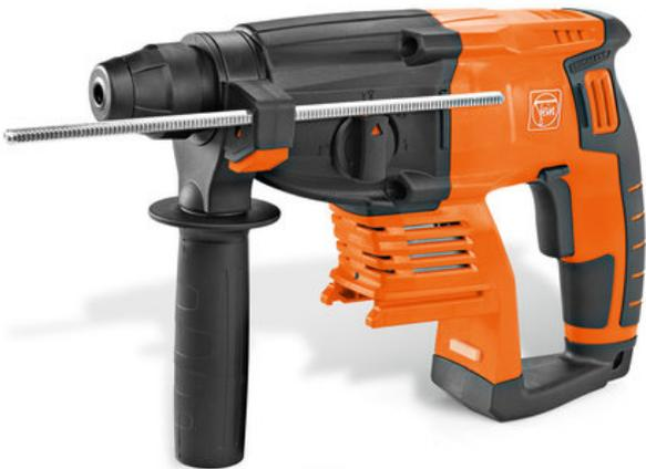
Marteau perforateur sans fil extrêmement compact et puissant, énergie d'impact de 2 j pour le perçage dans le béton jusqu'à 20 mm.
